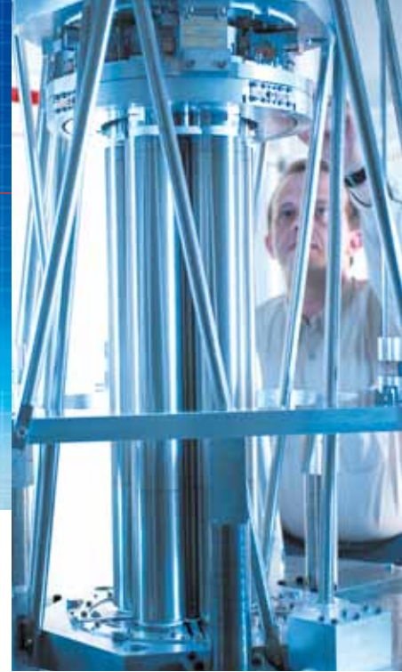
Nouvel étalon calculable de capacité électrique de Thompson-Lampard.
